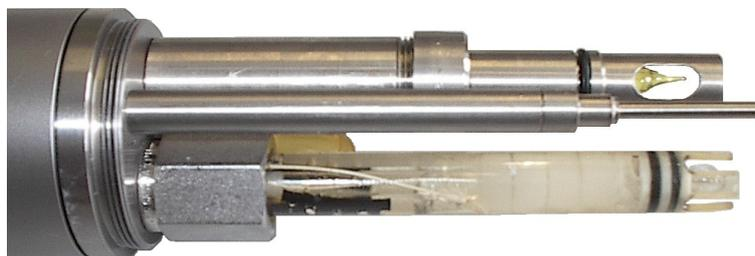
Abb.: Sonde ohne Schutzkorb mit Sensoren für H<sub>2</sub>O<sub>2</sub>, pH, Temperatur und Tiefe.
